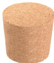
Korken wie aus einem Stück - **N - Klasse** Korkstopfen zeichnen sich durch die sehr feine Partikelstruktur aus, was der sehr gleichmäßigen Oberfläche zu Gute kommt. Um eine gleichbleibende Qualität zu erreichen werden alle Presskorken, nach der Pressung, in einem Brennofen bei 121°C getrocknet, was zu einer Sterilisierung der Stopfen führt. Bei einer sehr geringen Restfeuchte werden die Stopfen luftdicht verpackt, um jegliche Einflüsse auszuschließen. Die Partikelgröße liegt bei bis zu 3 x 3mm.
